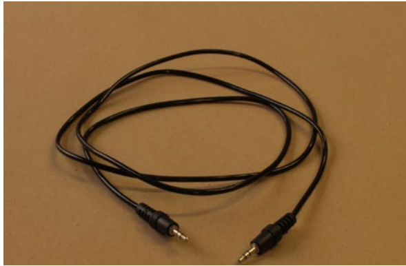
Figure 4.07. Mini jack audio cable.
