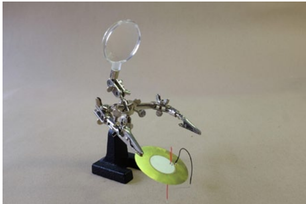
Εικόνα 4.12. Βοηθητικά χέρια με το πιεζοηλεκτρικό στοιχείο.
