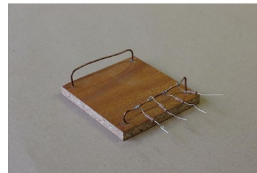
Εικόνα 6.02 Αυτοσχέδιος μείκτης για τέσσερα οργανάκια.
