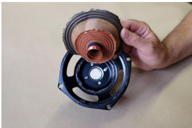
Εικόνα 2.14. Ένα αποδομημένο μεγάφωνο. Διακρίνεται το πορτοκαλί γυαλιστερό πηνίο του.
